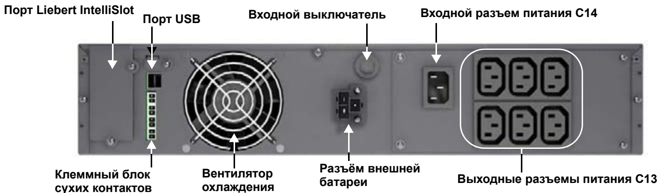
Рисунок 3 Компоненты задней панели, модели Liebert GXT3 230 В 2000 ВА
