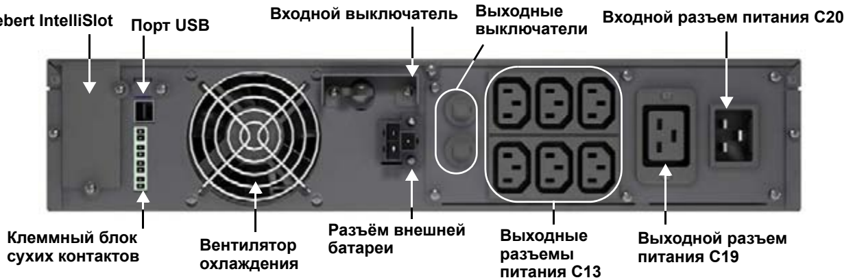
Рисунок 4 Компоненты задней панели, модели Liebert GXT3 230 В 3000 ВА
